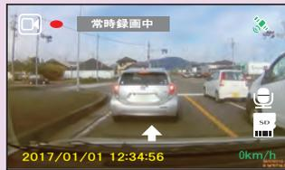
▲前車が発進しても自車が停止したままの場合、表示と専用アラーム音で警報します。
