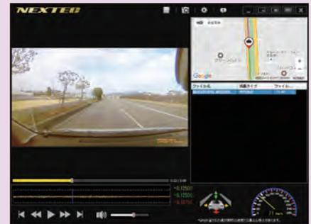
弊社ホームページより専用ビューアソフトをダウンロードすることで、記録した映像を Google Map と連動させて表示することができます。その他、走行スピード表示、Gセンサーグラフを表示できます。
