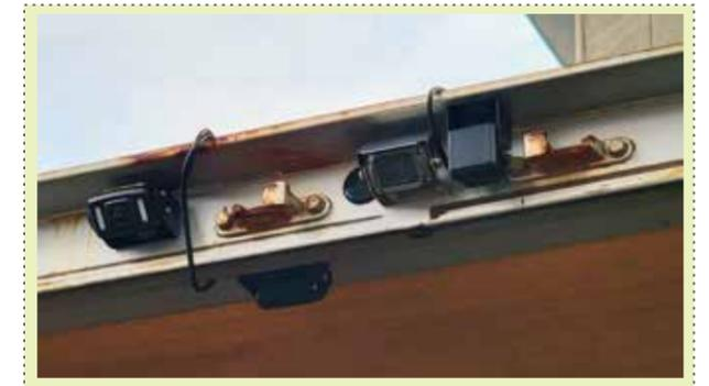
カメラ横のスペースにセンサーを1つ取付けるだけ
