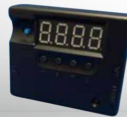
各種車載機器の電源を常時電源から一定時間、供給することが可能になります。
