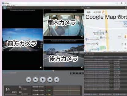
◀ 弊社ホームページより専用ビューアソフトをインストールすることで、記録した映像をパソコンで再生することができます。走行スピード表示、Google Mapと連動させて表示することができます。その他、Gセンサーグラフ表示等、詳細な情報を表示できます。
