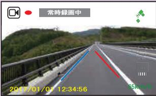
▲車線逸脱をすると表示と専用アラーム音で警報します。
