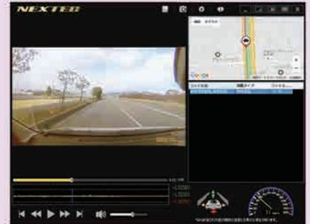
弊社ホームページより専用ビューアソフトをダウンロードすることで、記録した映像を Google Map と連動させて表示することができます。その他、走行スピード表示、Gセンサーグラフを表示できます。
