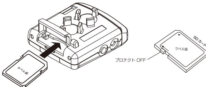
② SDカードのライトプロテクトはOFFにしてください。SDカードを本体のカード装着部に“カチッ”と音がするまで挿入します。このときカードの向きに注意してください。また、カードを抜く場合も同様に“カチッ”と音がするまで押してから引き抜いてください。
