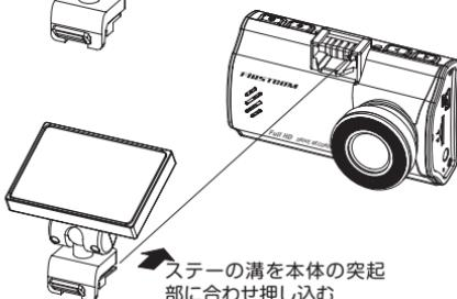
3. 車両の中央部から助手席側の運転に邪魔にならない場所をあらかじめ確認して、レンズを進行方向に向けてフロントガラスに貼り付ける
