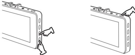
4. + - ボタンを押し、お好みの設定を選択して 記録 / 確定 ボタンを押して確定させる
