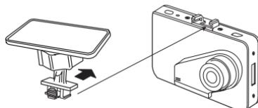
ステーの溝を本体の突起部に合わせ押し込む
