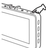
4. + - ボタンを押し、お好みの設定を選択して 記録 / 確定 ボタンを押して確定させる
