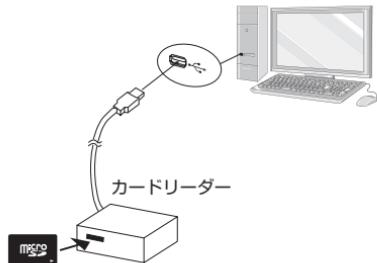
※ microSD/SDHC を直接接続できる
