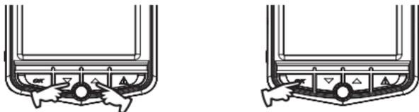
5. 同様に月、日、時刻を設定し、最後に“OK”ボタンを押し設定を確認させる
