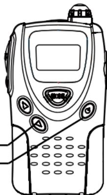
3. 確認音を鳴らさないようにするには、再度電源を切り、DOWN（ダウン）ボタンを押したまま、POWER（パワー）ボタンを押します。
