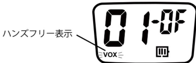
2. UP (アップ) / DOWN (ダウン) ボタンで 1 ~ 3 の音の感度を調整します。1 より小さな音に反応します。ハンズフリー機能を使用しない時は OF を選択してください。
