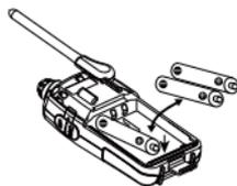
\* 初回、本体へ電池を装着するときに初期設定モードが働き、本体の電源が自動的に ON となります。
