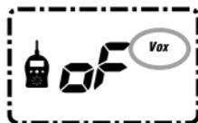
2. “UP”/“DOWN” キーで 1～5 の音の感度調整をします。5 より小さな音に反応します。ハンズフリー機能を使用しない時は、oF を選択してください。
