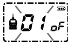
2. “UP/DOWN”キーを長押しすると、チャンネルスキャンが始まります。“UP”キーで今のチャンネルから順に進む方向にチャンネルをスキャンします。“DOWN”キーを長押しすると、戻る方向にチャンネルをスキャンします。
