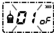
目的のチャンネルを選択する際に「通話チャンネルについて」を参考にチャンネルを選択してください。中継機対応のチャンネルの場合、RPTアイコンが点灯します。
