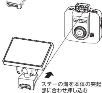
3. 車両の中央部から助手席側の運転に邪魔にならない場所をあらかじめ確認して、レンズを進行方向に向けてフロントガラスに貼り付ける
