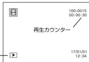
**記録 / 確定** ボタンを押すと再生を開始します。再生を一時停止するときは、**記録 / 確定** ボタンを押してください。(▶マークが || マークに変わります)
