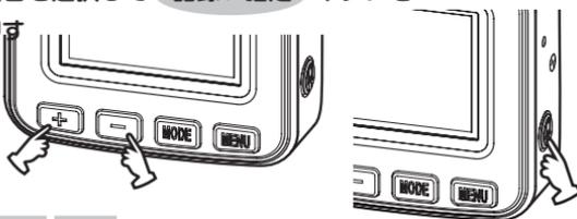
4. **+** **-** ボタンを押し、お好みの設定を選択して **記録 / 確定** ボタンを押して確定させる
