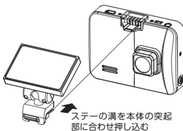
3. 車両の中央部から助手席側の運転に邪魔にならない場所をあらかじめ確認して、レンズを進行方向に向けてフロントガラスに貼り付ける
