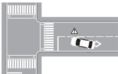
車線逸脱警報は時速 60km/h 以上で動作します。
