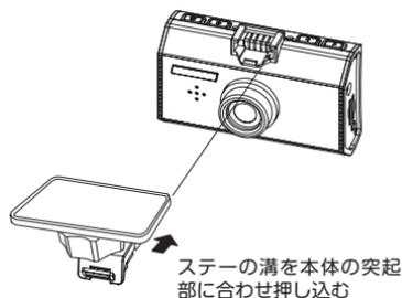
3. 車両の中央部から助手席側の運転に邪魔にならない場所をあらかじめ確認して、レンズを進行方向に向けてフロントガラスに貼り付ける
