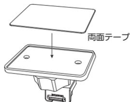
2. 本体の取り付けステー装着部の突起部にステーの溝を合わせ“カチッ”と音がするまで押し込む
