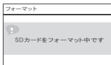
「SD カードをフォーマット中です」が表示され、「ファイルをすべて削除します」とアナウンスされます。続けて「SD カードの完全フォーマット」が表示され、「ファイルをすべて削除しました」とアナウンスされ、設定メニューに戻り、フォーマット完了です。
