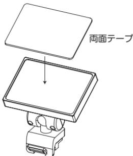
2. 本体の取り付けステー装着部の突起部にステーの溝を合わせ“カチッ”と音がするまで押し込む
