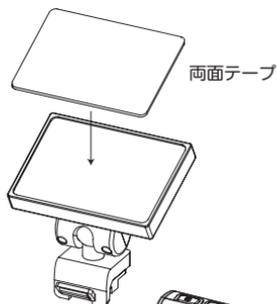
2. 本体の取り付けステー装着部の突起部にステーの溝を合わせ“カチッ”と音がするまで押し込む
