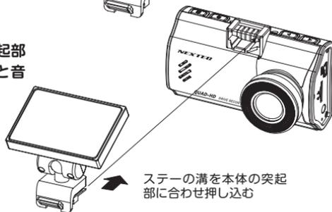
3. 車両の中央部から助手席側の運転に邪魔にならない場所をあらかじめ確認して、レンズを進行方向に向けてフロントガラスに貼り付ける
