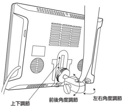
※角度、高さを調節し、固定ねじ 3箇所でしっかりと固定します。
