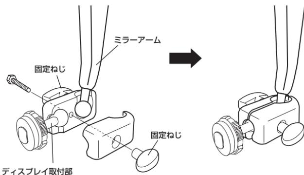
※ミラーアーム取付アダプターをミラーアームの球体部とディスプレイ取り付け部の球体部を挟み、2箇所のねじで仮止めします。
