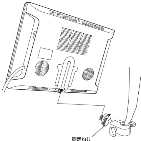
※先端の突起をディスプレイの溝に合わせライドし、適当な位置で、固定ねじで仮止めします。
