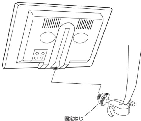
※先端の突起をディスプレイの溝に合わせスライドし、適当な位置で、固定ねじで仮止めます。
