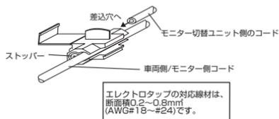
2. プライヤー等で金属端子を完全に押し込み、接続後にカバーを倒しロックします。
