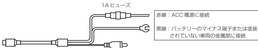
③サイドカメラ用電源・映像ケーブルを車両の ACC 電源、マイナスアースに接続します。
