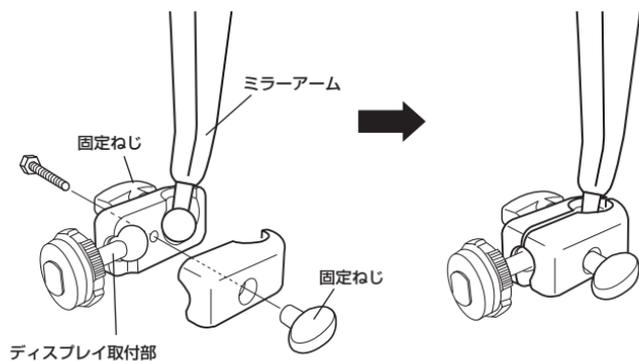
※ミラーアーム取付アダプターをミラーアームの球体部とディスプレイ取り付け部の球体部を挟み、2箇所からねじで仮止めします。
