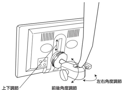
※角度、高さを調節し、固定ねじ3箇所ですっかりと固定します。
