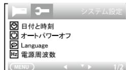
3. ▼ (DOWN) キーを1回押して日時設定にカーソルを移動してから、録画スタート/ストップキーを押す。
